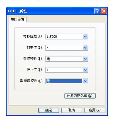
第2步: 打开转换器电源,在启动的前 5秒钟,看到以太网 LINK, ACT 指示灯亮,请在指示灯灭前,输入 CTRL+B键,进入 BIOS 模式,如下图所示:
