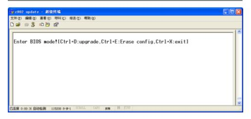
第 3 步: 进入 BIOS 模式后,会看到 "Enter update mode! [Ctrl+D: upgrade, Ctrl+E: Erase config, Ctrl+X: exit]"的文字,如果需要升级则输入 CTRL+D键:首先会提示 "Erasing FLASH. Please wait...",表示正在擦除 Flash,接着会看到"If display'C',please use the Xmodem protocol to upgrade.",提示如果在不停的显示 C,则就开始开始使用 Xmodem 协议来升级了,如下图所示:
