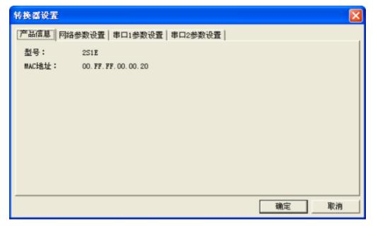
点击"产品信息"按扭,可以查看到转换器的型号,MAC地址。 点击"网络参数设置"按扭,可为设备指定 IP 地址、掩码和网关。
