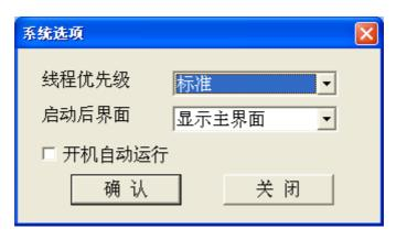
线程优先级:有标准,高于标准,高,低于标准;用来设置虚拟串口服务器程序占用 CPU 资源的优先级,用户可以采用默认。
